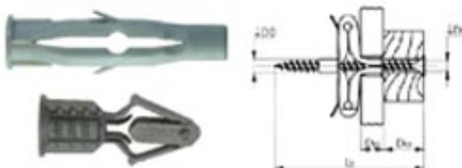
Šis kaištis skirtas įtvirtinti medžiagą į betoną, pilnavidures ir tuščiavidures plytas, taip pat gipskartonio plokštės. Jis atlieka iškart du veiksmus: skečia ir lenkia. Tvirtinant tuščiavidurėse konstrukcijoje išsiskėtę plastikinės dalies sparneliai iš vidaus pritvirtina detalę. Šiemis kaiščiams tvirtinti naudojami universalūs medusraigčiai.
